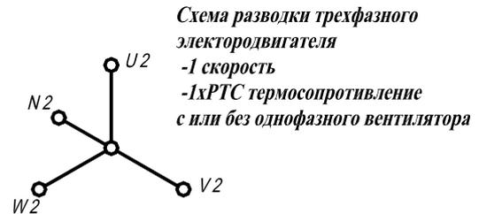
Схема разводки трехфазного электродвигателя
