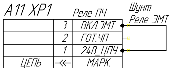
Рисунок 10 Модуль A11. Шунтирование Реле ЭМТ в ПЧ
