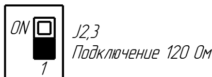
Рисунок 78 J2, J3 Положение ON. Сопротивление подключено
