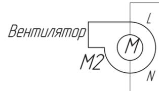
Вариант 2. Переменная работа вентилятора ГД при включении KM4
