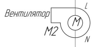
Вариант 3. Переменная работа вентилятора ГД при срабатывании термовыключателя двигателя
